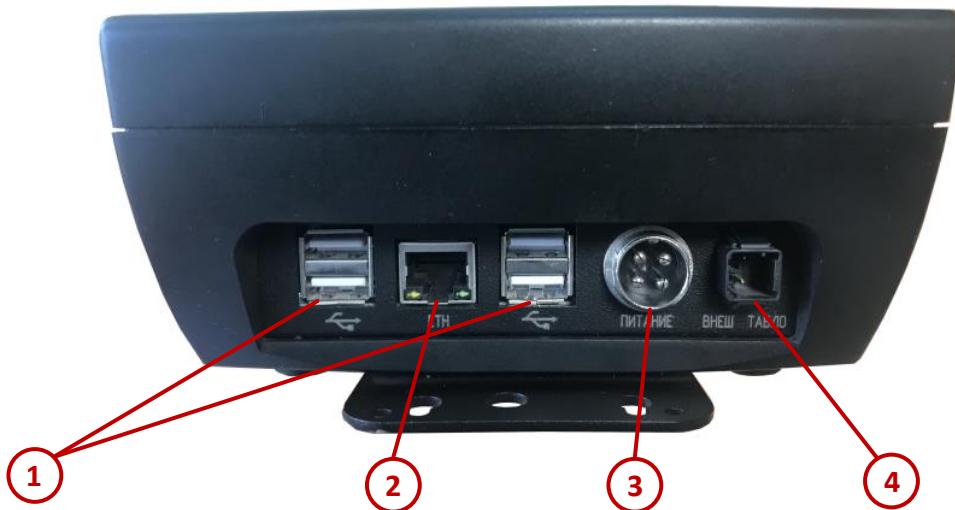
Рисунок 2. Расположение разъемов TSCT-01-01
