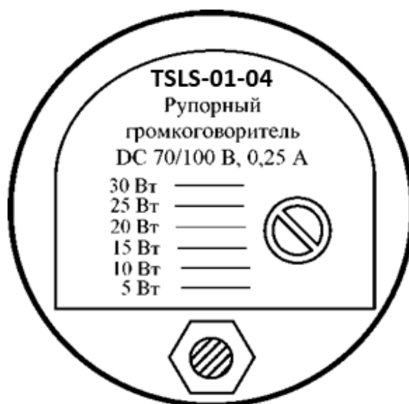
Рисунок 3. Внешний вид задней панели TSLS-01-04
